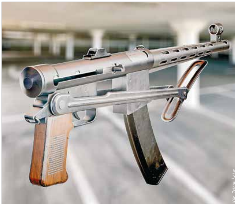
A Kuchner József által tervezett K1 nevű géppisztoly nem sokban tért el a szovjet társától, elsősorban a visszahajtható válltámaszban különbözött
